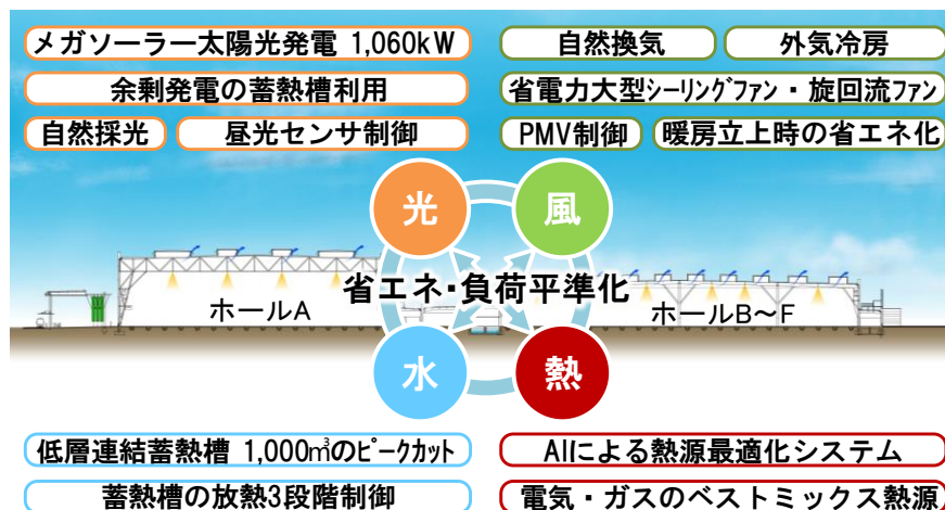
図 光・風・水・熱源の最適運用による省エネルギー・負荷平準化
